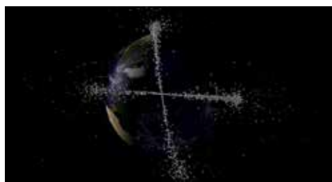
Simulierte Fragmente der Kollision zwischen den Satelliten Iridium 33 und Kosmos 2251. Quelle: Institut für Raumfahrtsysteme (IRAS), TU Braunschweig
