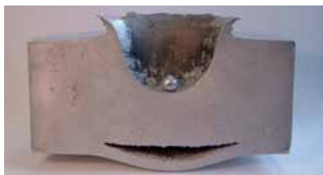
Einschlagkrater einer 1,2 cm Aluminiumkugel mit 6,8 km/s in einen massiven Aluminiumblock. Quelle: ESA
