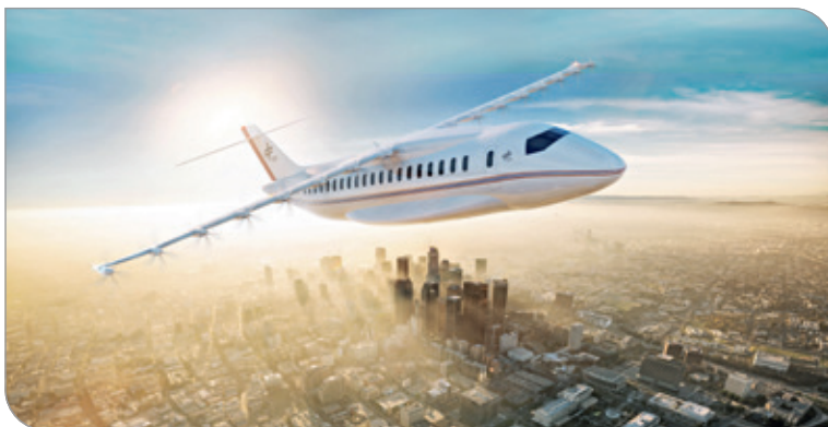
Entwurf für ein hybrid-elektrisches Flugzeug mit verteilten Antrieben. Credit: DLR (CC BY-NC-ND 3.0)
