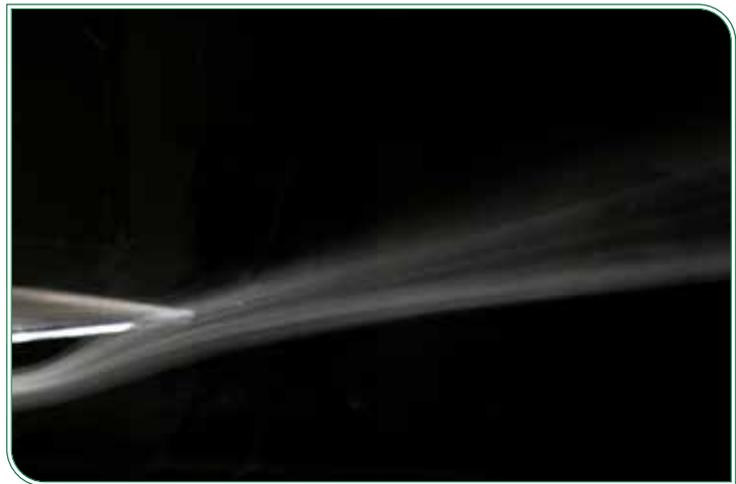
Visualisierung der Strömungsumlenkung an der Hinterkante eines Windkanalmodells mit aktiver Ausblasung zur Böenlastreduktion.
