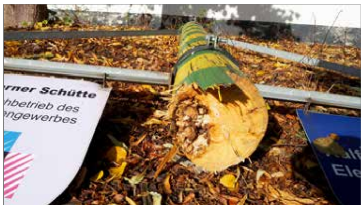
Deutlich sichtbar: Die Schäden am Holz des Wappenbaums Foto: Jochen Wanning
