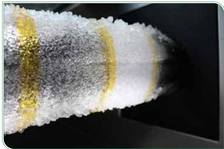
Vereister Testzylinder mit verschiedenen mikrostrukturierten Folien im Braunschweiger Eiswindkanal des Instituts für Strömungsmechanik der TU Braunschweig.
