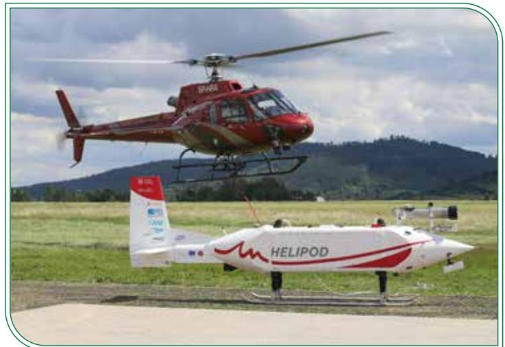
HELiPOD wird mit einem Seil vom Hubschrauber geschleppt.
